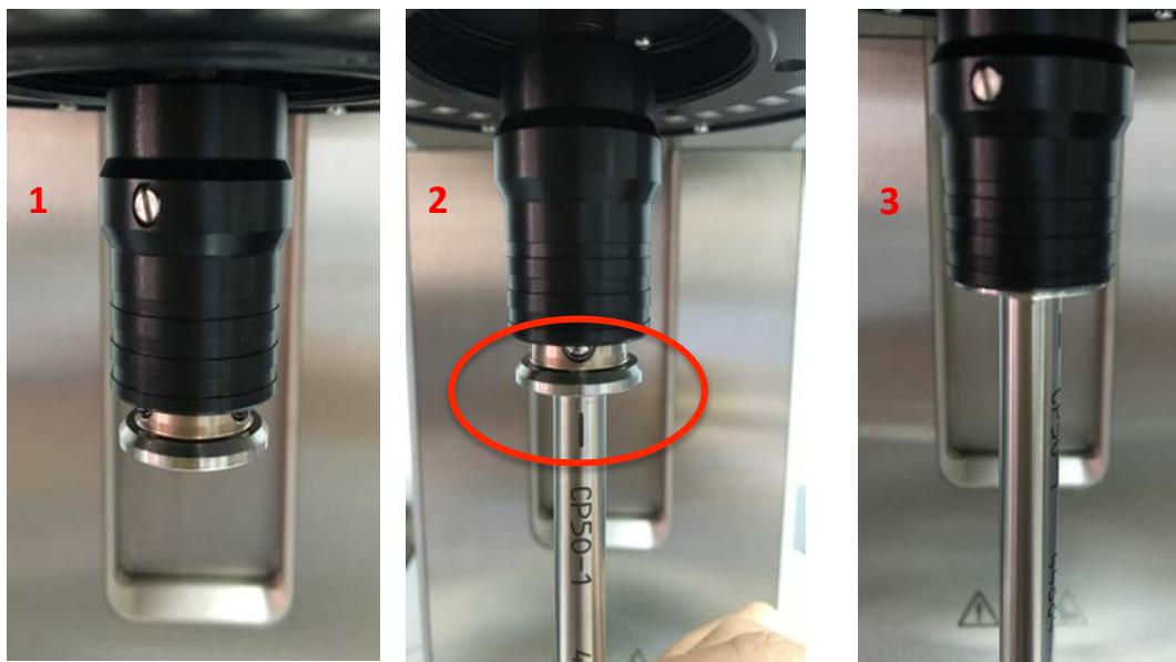
**3. 更換控溫系統**：此處以 P-ETD 跟 C-PTD 系統對換為示範
