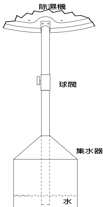
清空集水器時，應先關閉球閥，以避免空氣進入手套箱中。排水管之末端開口應完全浸沒在水箱中。您必須在一開始建立厭氧環境設定時，便將水加入集水器中。最後再將設備插上插座。應使用單獨的濕度計（Coy 不提供，客戶需自備）來準確監測手套箱內部的濕度。
