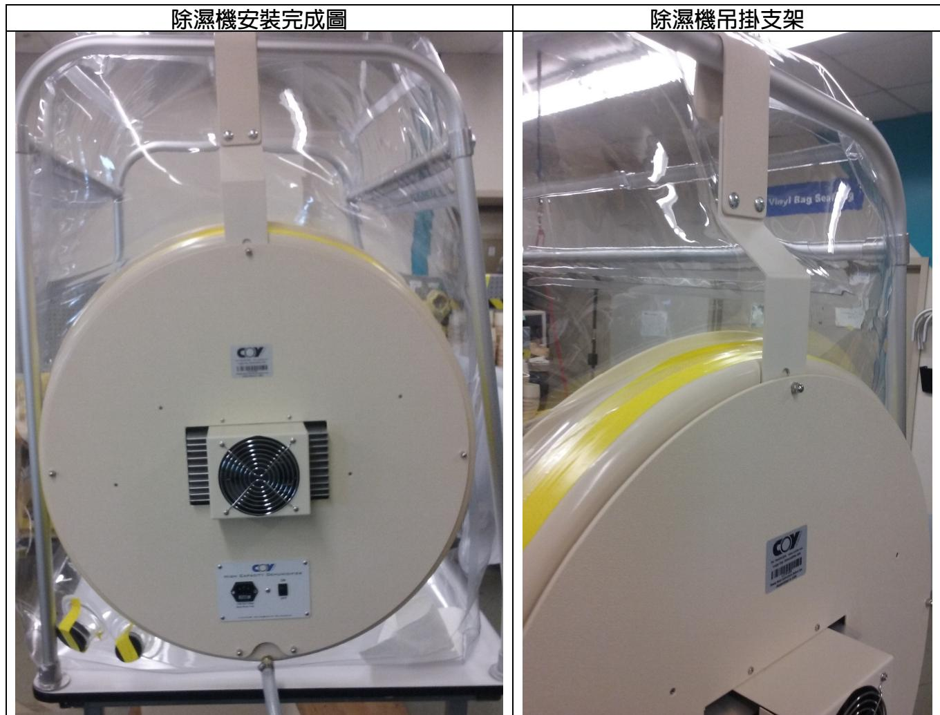
固定除濕機後，將乙烯箱壁拉到除濕機圓盤周圍；建議用一隻手先固定住乙烯箱壁一側，另一隻手當成槓桿，小心將乙烯箱壁拉伸到除濕機圓盤上。當全部的乙烯箱壁都拉伸到除濕機圓盤上後，再用Coy提供之乙烯膠帶密封乙烯箱壁和除濕機圓盤連接處。
