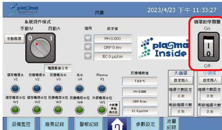
3. 點擊「長壓循環起停開關」，此時電漿反應槽注入 RO 水，待水位到達，機器自動開啟電漿產生器產生電漿活化水
