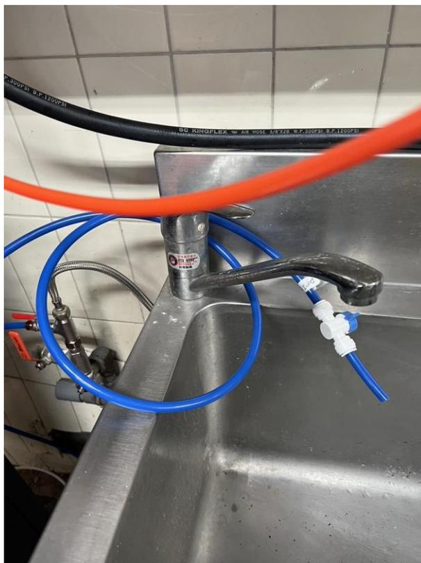
1. 當 PAW 達到設定生成條件時，電漿產生器停止作用，於右側藍色水管取 PAW
